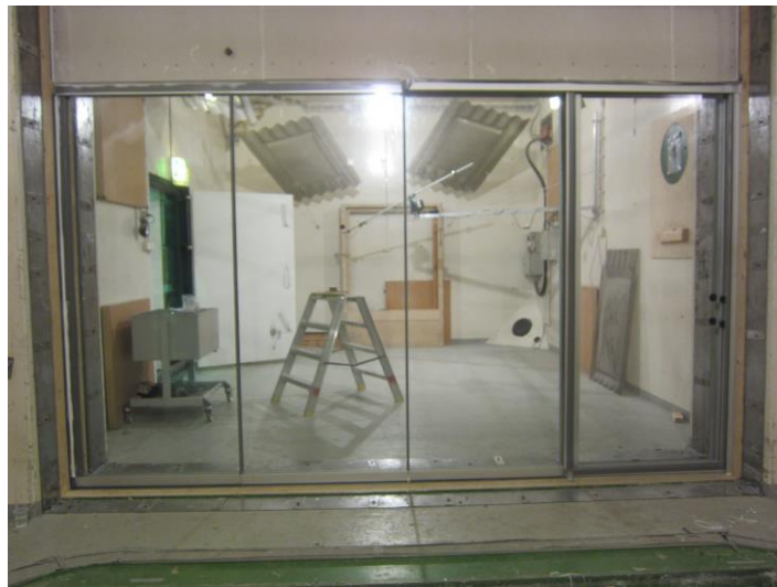
Kuva 2, Seinien asennus kaiuntahuoneiden väliseen mittausaukkoon (kuva on asennustapakuva kuvassa ei ole mitattu seinä.)
